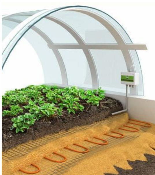
Рисунок 2. Обогрев грунта в теплице.
