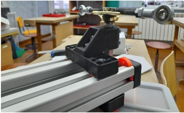
Рисунок 3. Станина и корпус для размещения шагового двигателя.
