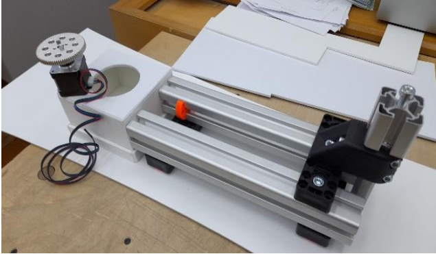
Рисунок 3. Станина и корпус для размещения шагового двигателя.
